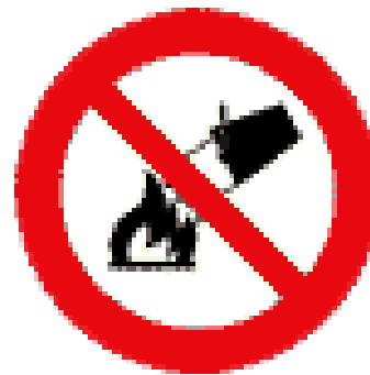
Vietato spegnere con acqua
